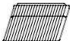
**Soporte desmontable:** Este soporte se sitúa en el lado derecho y en el lado izquierdo del horno, pudiéndose quitar para limpiar las paredes del horno. (sólo para modelos específicos).
