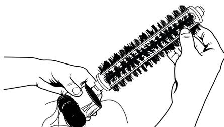
**⚠** El exceso de pelo puede dañar el Roomba permanentemente. Retire los cepillos e inspeccione los cojinetes habitualmente.
