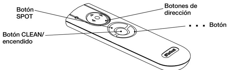
El control remoto permite controlar adecuadamente las funciones de Roomba. Puede utilizarlo para encender y apagar el Roomba y guiarlo por una habitación sin tener agacharse. También permite acceder de forma remota a los siguientes comandos:
