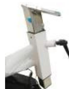
Lösen Sie den Verriegelungsbolzen entgegen gestzt dem Uhrzeigersinn und stellen Sie die Höhe des Lenkers ein. Drehen Sie anschließend den Verriegelungsbolzen im Uhrzeigersinn fest.
