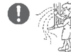
Cada pieza en que se utilice la estufa, debe estar provista de una entrada de aire suficiente y de una salida de aire eficaz (sección mínima de 50 cm<sup>2</sup> para cada orificio).
